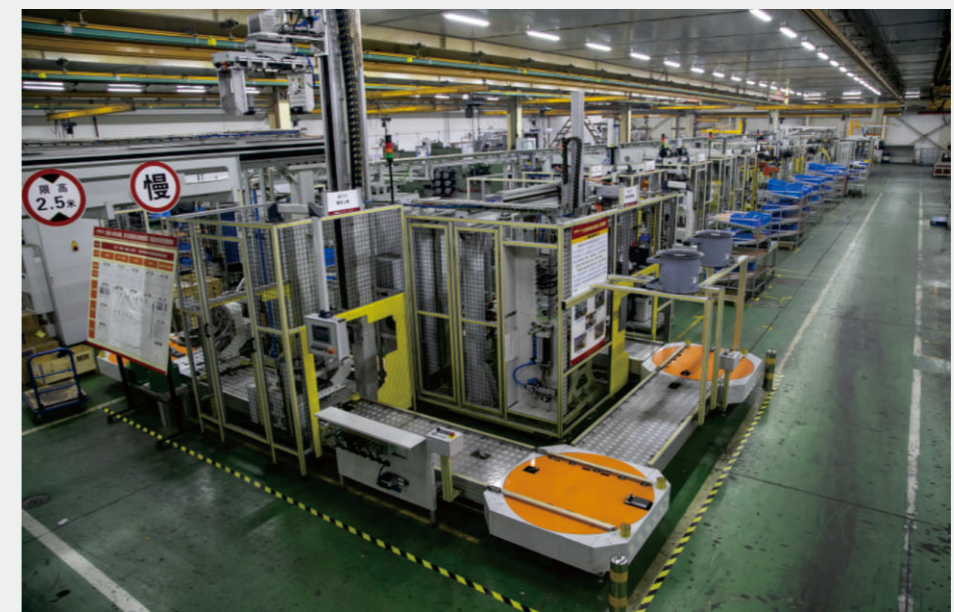
▲ 变速箱总成智能装配线
